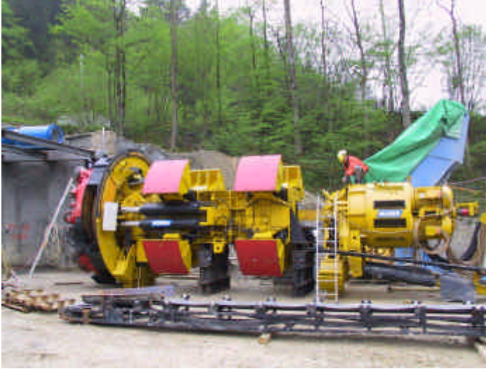
Transportstollen Filderer – Reppischtal: TBM Wirth TB II 300/360 E
