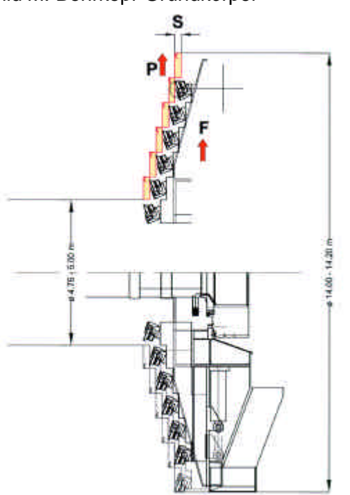
Bild N: Längsschnitt Bohrkopf und Kraftfluss
